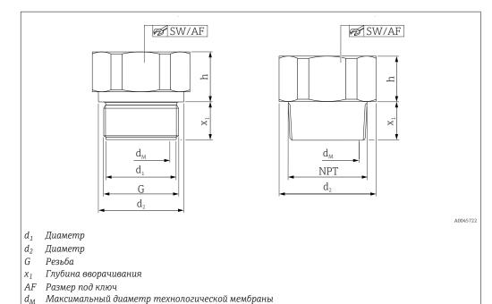
Единица измерения – мм (дюймы). Слева – резьба ISO 228, справа – резьба ASME Схематическое изображение, фактическая конфигурация может быть другой.
