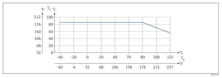
🗉 4 Значения действительны для вертикального монтажа без изоляции.
