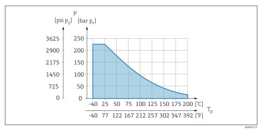
Для эксплуатации в условиях разрежения:  $p_{a6c.} \le 1$  бар (14,5 фунт/кв. дюйм) до 0,05 бар (0,725 фунт/кв. дюйм), при температуре не более +150 °C (302 °F).
