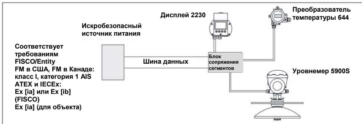
Рисунок 3-19. Пример искробезопасной системы FOUNDATION fieldbus с приборами системы учета в резервуарах Rosemount
