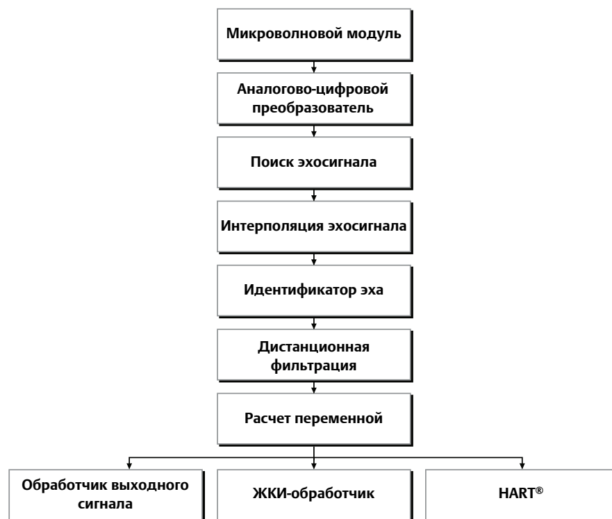
Рисунок 2-2. Блок-схема обработки сигнала
