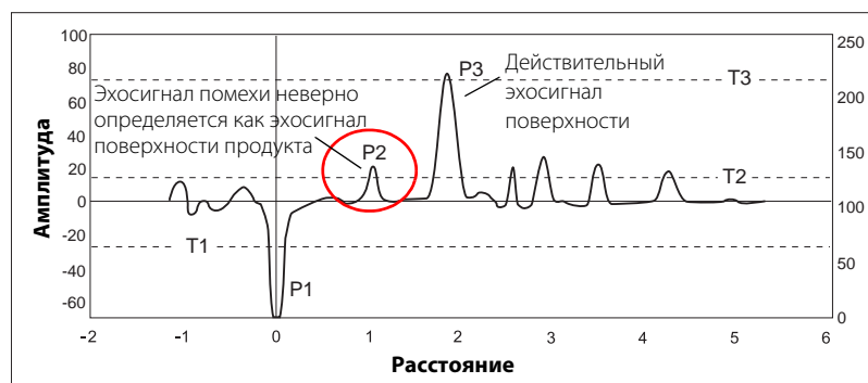
Рисунок 6-11. Пример 2: амплитудный порог T2 установлен слишком низко
