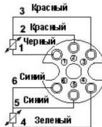
Рисунок И.4 – Трехпроводная схема ТС с двумя ЧЭ (код выводных проводников измерительной вставки 2)
