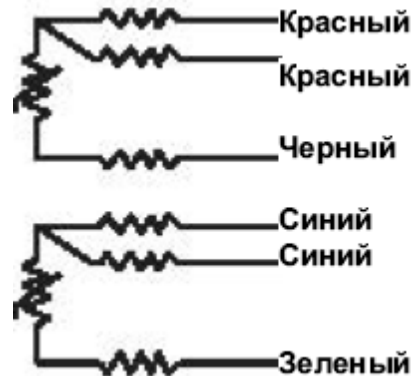
Рисунок И.2 – Трехпроводная схема ТС с двумя ЧЭ (код выводных проводников измерительной вставки 0 и 3)
