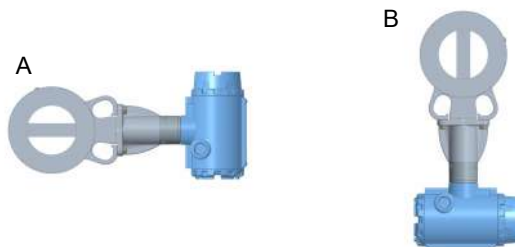
Рисунок 3-4. Примеры установки в высокотемпературных условиях
