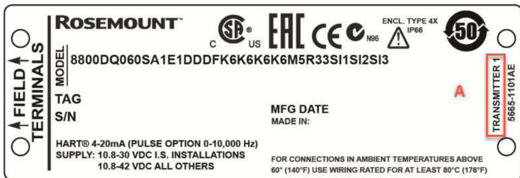
Рисунок 4-14. Маркировочная табличка счетверенного преобразователя
