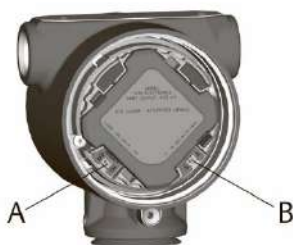
Рис. 6-2. Настройка системы безопасности и аварийных сигналов (опция D1)
