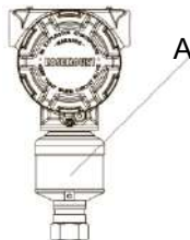
Рис. 3-8. Отверстие со стороны низкого давления встраиваемого измерительного преобразователя избыточного давления
