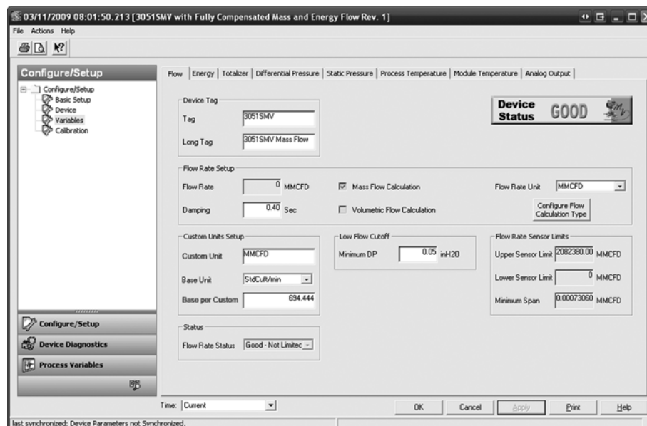
Рисунок 2-28. Пользовательские единицы измерения расхода — пример пересчета массы/объема и времени
