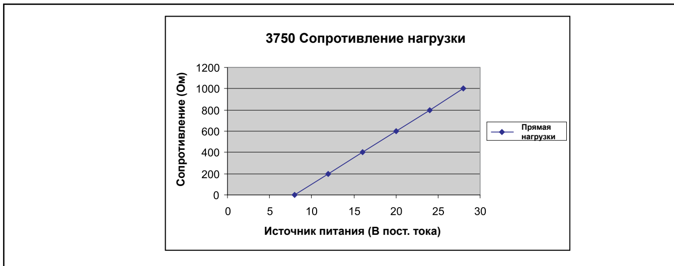
Рисунок 1-2 Источник питания и максимальное сопротивление нагрузки
