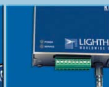
Разъём с винтовым креплением контактов
