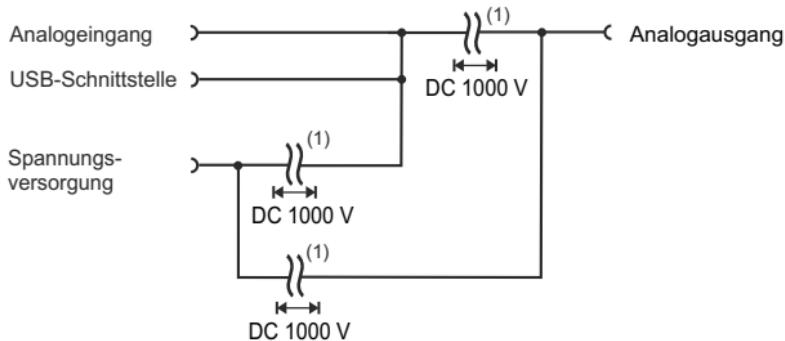
(1) Die Spannung von DC 1000 V zwischen den Schaltungsteilen, ist eine Prüfspannung.
