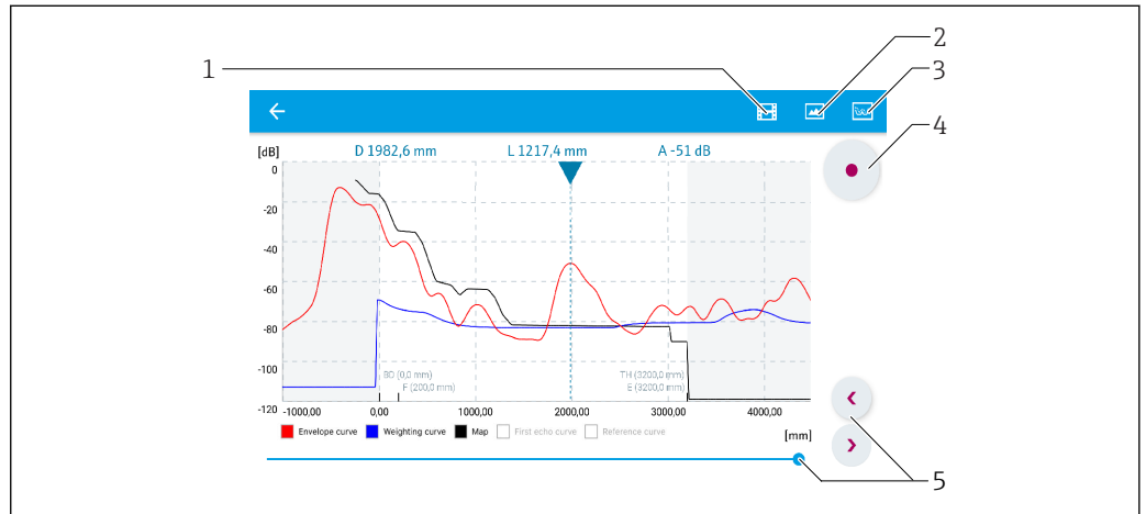
30 Отображение огибающей кривой (пример) в приложении SmartBlue; устройство Android
