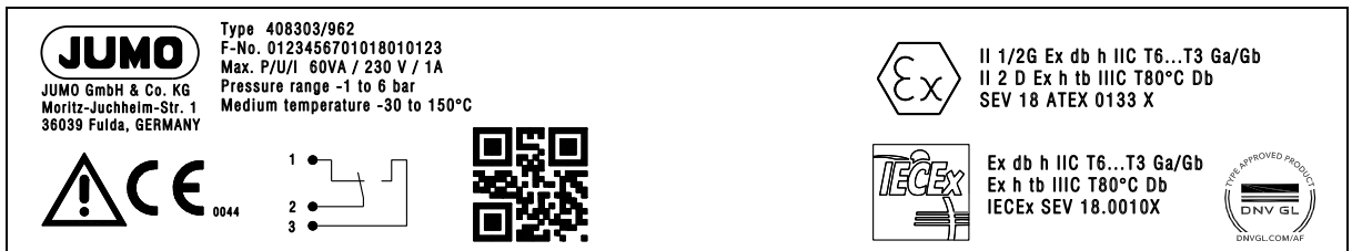
Abb. 3-5 Typenschild in Ausführung Explosionsschutz druckfeste Kapselung, Ex d, und Schiffbau
